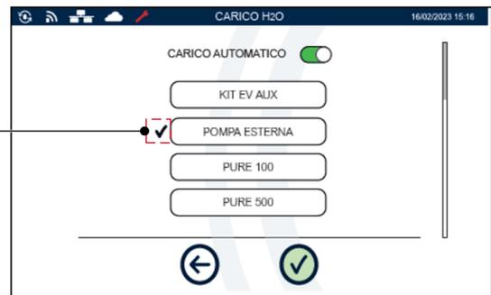
Al conectar el sistema de carga automática, la esterilizadora solicita la identificación del tipo de dispositivo efectivamente conectado presionando la tecla correspondiente.
