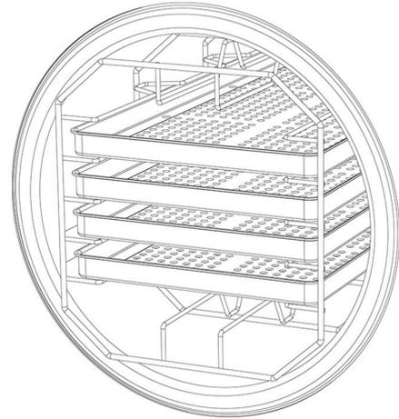
O bien, extrayendo el soporte portabandejas y girándolo de 90° puede ser usado para alojar "cajas" (3/ 4 compartimientos según el modelo de esterilizadora).
